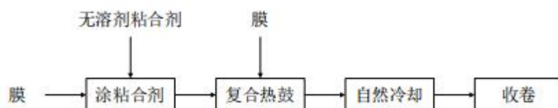
图 3-5 无溶剂复合示意图
