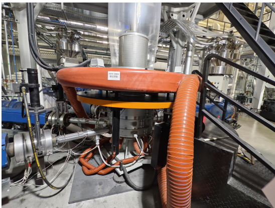
1号厂房挤出废气收集设施风环
