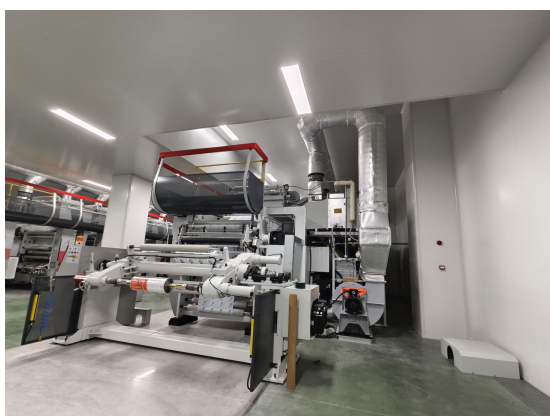
1号厂房印刷、复合废气收集设施
