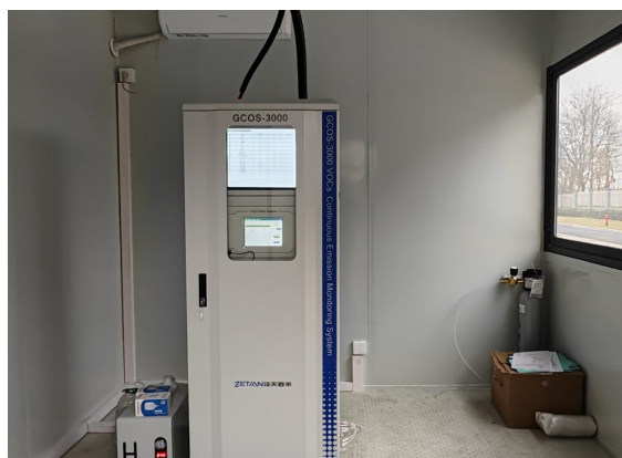
1号厂房印刷、复合废气在线监控
